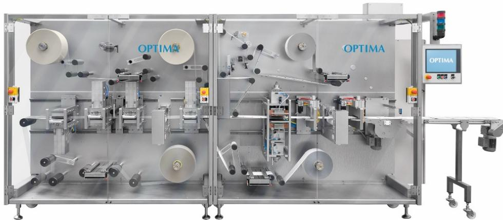
Mit der OPTIMA TDC 125 von Optima Life Science lassen sich orale Filmstreifen und Transdermalpflaster in kleinen und mittleren Produktionsmengen herstellen.
